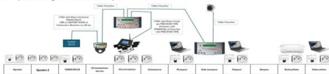
Exemple de câblage d'une table de marque:
